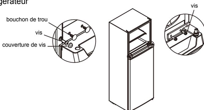
4) Démontez la charnière inférieure, les bouchons et les vis, installez l'axe de la charnière inférieure et réglez le pied de l'autre côté de la charnière inférieure, puis installez la charnière de l'autre côté.
