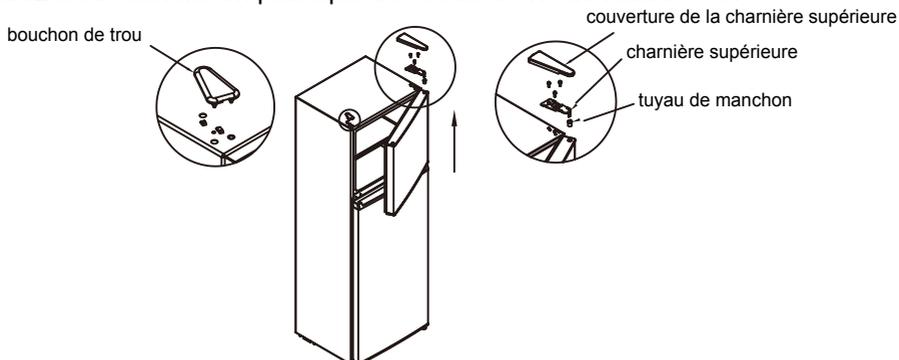
3) Démontez la charnière centrale, les bouchons des trous de vis et retirez la porte du réfrigérateur
