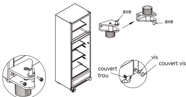
5) Démontez la vis, le tuyau de manchon et le bouchon de la porte du réfrigérateur et de la porte du congélateur. Le support du couvercle inférieur de la porte du réfrigérateur est également retiré. Ensuite, installez-les de l'autre côté de la porte. Échangez la position du tuyau de manchon et du capuchon du trou sur le capot supérieur de la porte de réfrigération et installez le manchon de charnière supérieur de la porte du congélateur sur le trou situé de l'autre côté du manchon d'axe.
