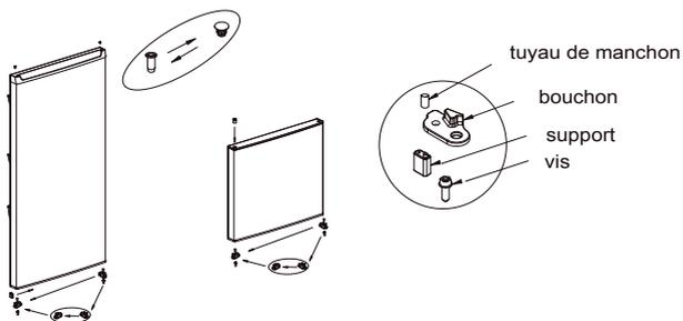
6) Placez la porte froide sur la charnière inférieure, installez la charnière centrale, le couvercle, les vis et le capuchon à visser.
